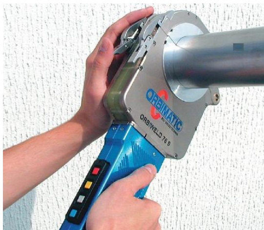
5. ábra Zárt fej rögzítése csövön
