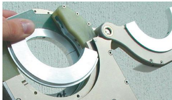
4. ábra Szorítópofa cseréje zárt rendszerű fejen
